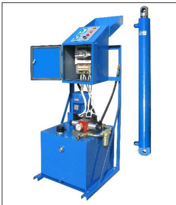
Aktuator za oscilatorna kretanja 90-0300 koristi se na mestima gde je potrebno da se obavljaju naizmeni na kretanja sa fiksnom amplitudom koja odgovara hodu cilindra. Kretanje klipnja e cilindra može biti neprekidno bez zaustavljanja od jednog do drugog krajnjeg položaja klipnja e cilindra ili sa zadrškom (pauzom) u jednom od dva položaja. Kako se za promenu smera ne koriste krajni mikroprekida i to je mogu a ugradnja u vrlo prljavim i vlažnim sredinama.
